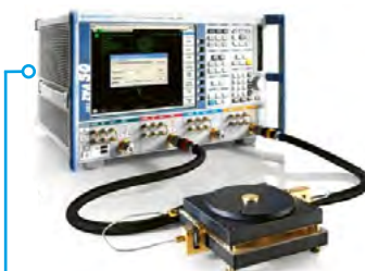
Измерение параметров пленок на основе резонатора
