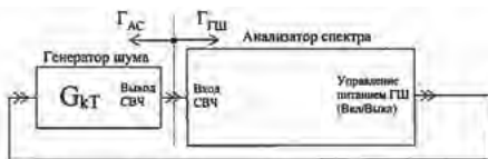
Рисунок 1а. Измерение собственного КШ анализатора спектра
