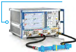
Измерение параметров материалов в волноводе
