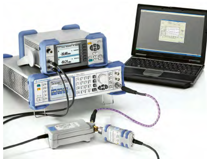
Измерительная установка для калибровки преобразователя мощности NRP-Z55
